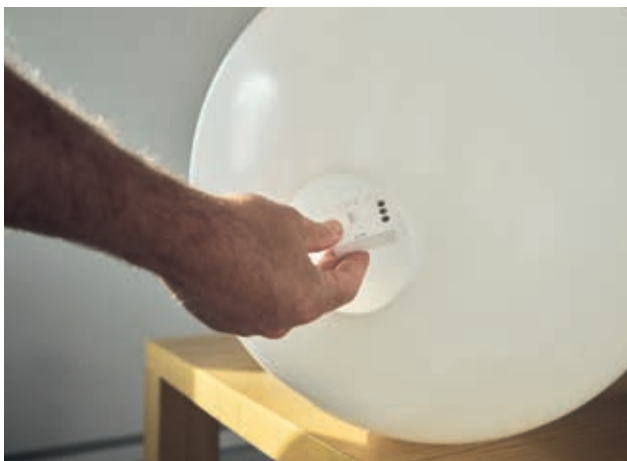
Bild 1 Integration der Sensorik in einen geschlossenen Leuchten-Körper.
