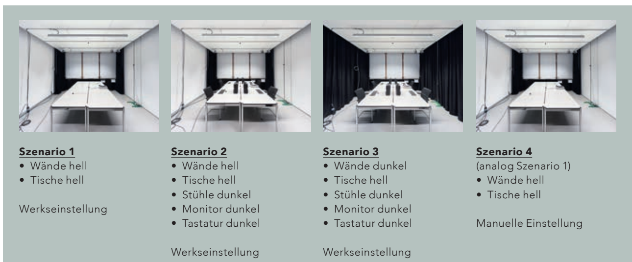
Abbildung 1 Testraum zur Messung der Funktions- und Leistungsfähigkeit von Sensoren
