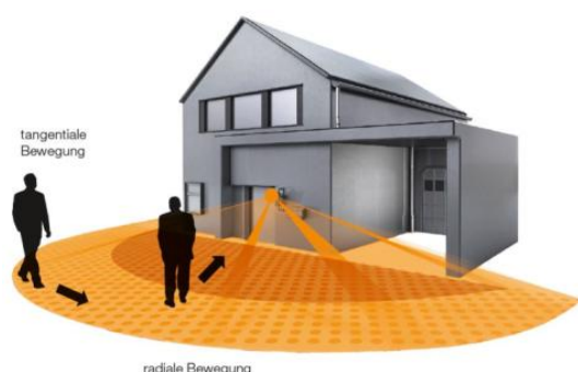
Abbildung 6: Visualisierung der tangentialen und radialen Erfassung eines PIR-Sensors
