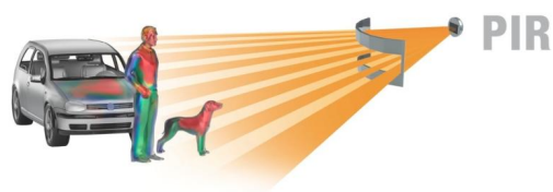
Abbildung 11: Erfassungsschema Passiv-Infrarot-Sensor (PIR)
