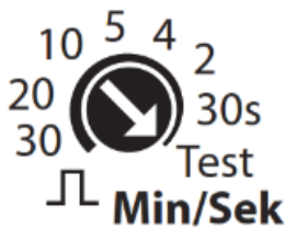
Abbildung 31: Potentiometer zur Einstellung der Nachlaufzeit
