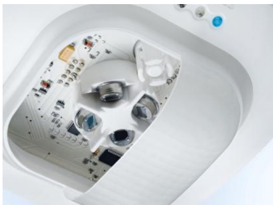
Abbildung 14: Einblick in einen PIR-Melder: sichtbar sind vier Pyrosensoren und die typische Linsestruktur
