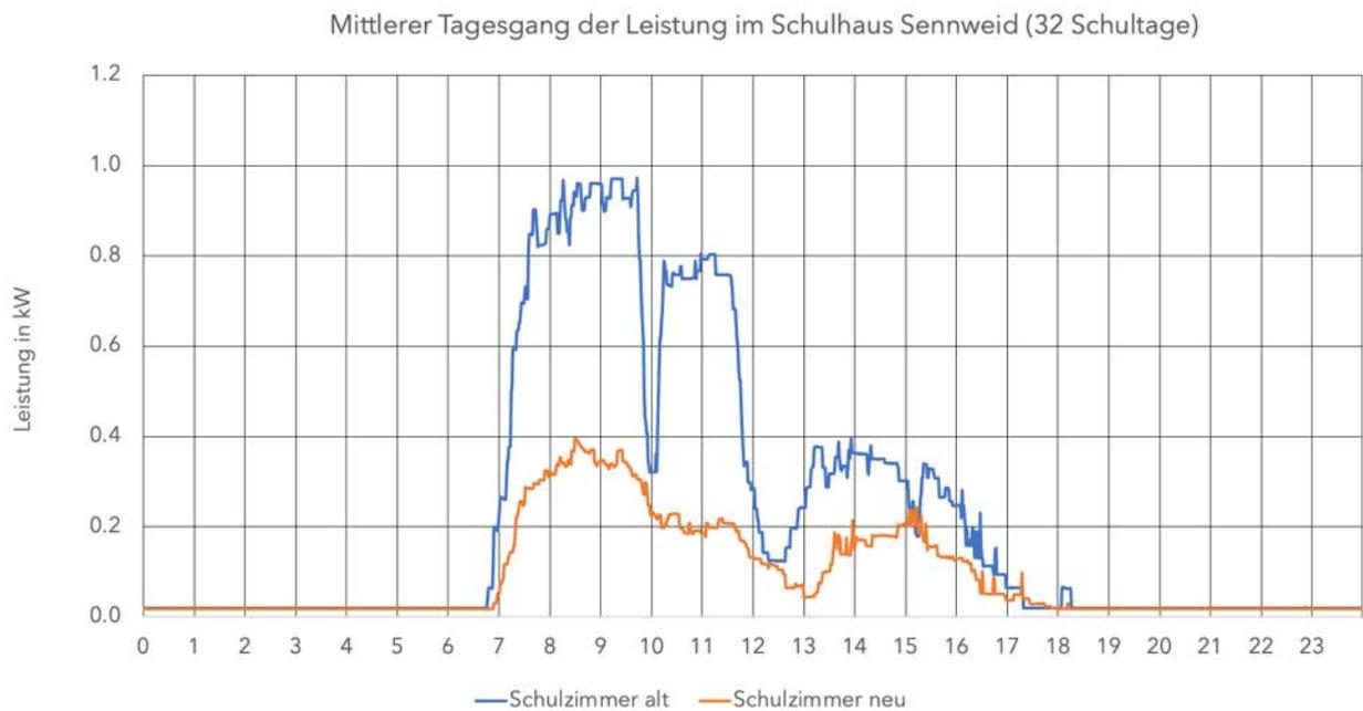
Abbildung 11: typischer Tagesgang der Leistung an Tagen mit ganztägiger, übereinstimmender Belegung
