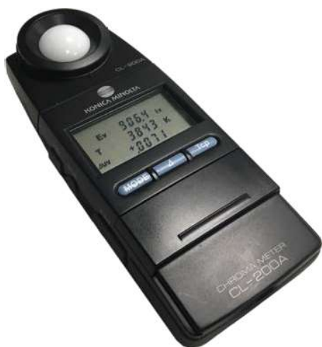
Figure 6 : Appareil de mesure de l'éclairement de Minolta
